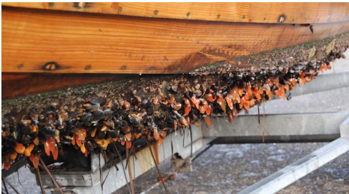
**Figura 38** - Casco de embarcação com bioincrustação, o segundo vetor mais frequente de introdução de invertebrados marinhos em temas globais (Fonte: Wikimedia Commons).
