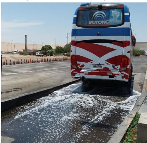
**Figura 30** – Exemplo de rodilúvio usado para limpeza da parte inferior da carroceria de veículos.
